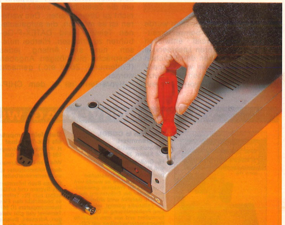
So kommen Sie ans Innenleben der Commodore-Floppy : alle Stecker abziehen und vier Schrauben auf der Unterseite lösen
